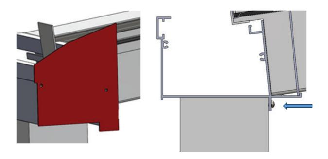
Placez la gouttière sur le dessus des poteaux et fixez la mécaniquement à ceux-ci grâce à la lèvre se trouvant sur la partie inférieure du profilé. La descente peut être placée dans ou contre un poteau (avec l'aide des colliers).
